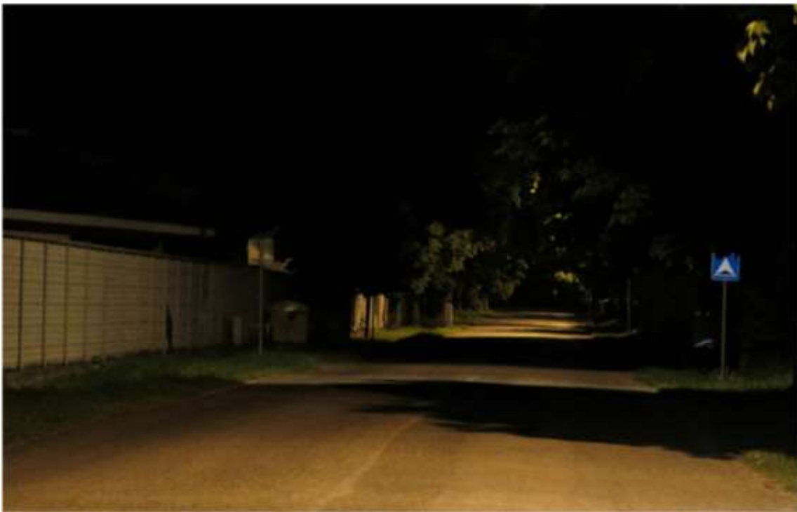
Obrázok č. 126 - Výrazné tmavé tieňe na komunikácii so stromoradiím (Pri gaštanovej aleji)
