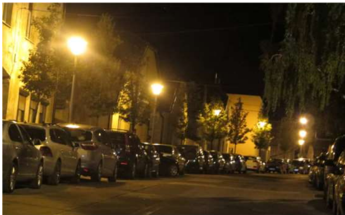
Obrázok č. 118 - Horšia rovnomernosť osvetlenia parkovými svetidlami na Alstrovej ulici
