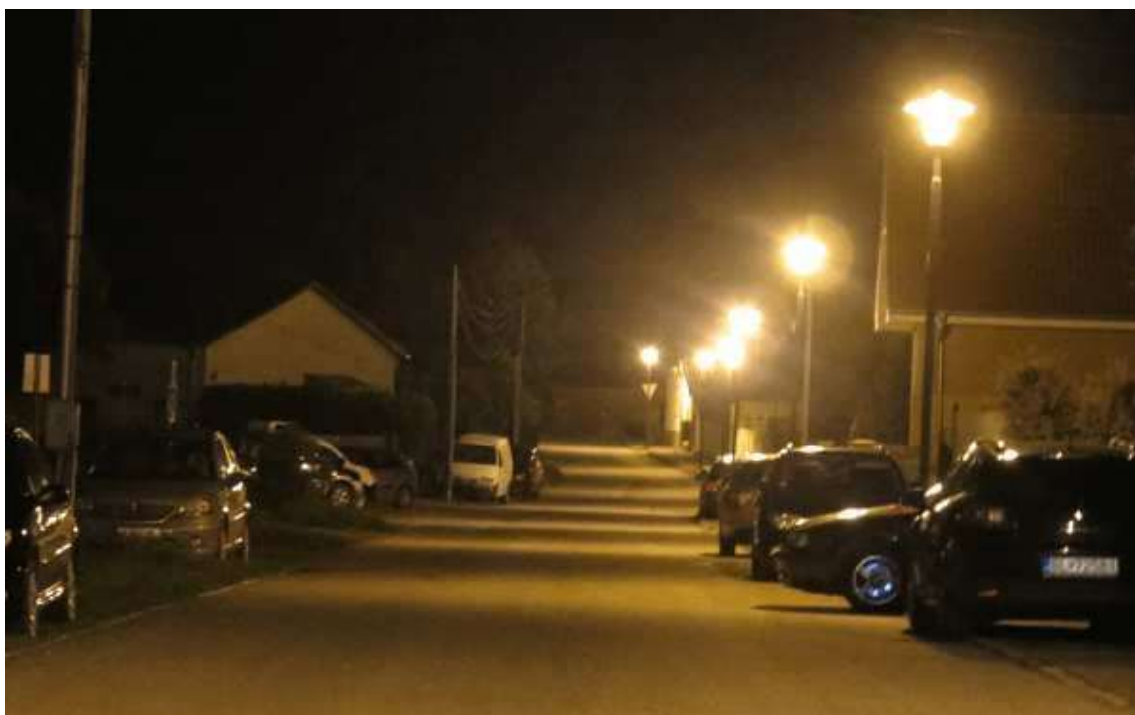
Obrázok č. 116 - Typické „pruhovanie“ so zhoršenou pozdĺžnou rovnomernosťou osvetlenia na Chotárnej ulici
