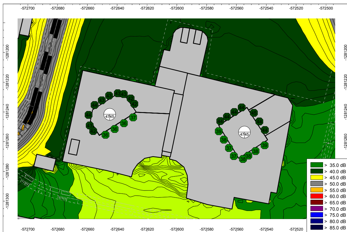
Obr. 12 Vypočítaná plošná hluková záťaž vo výške 1,5 m nad terénom a hodnoty ekvivalentný hladín A zvuku pred fasádami povražísk opery a činohry vo večernom referenčnom čase
