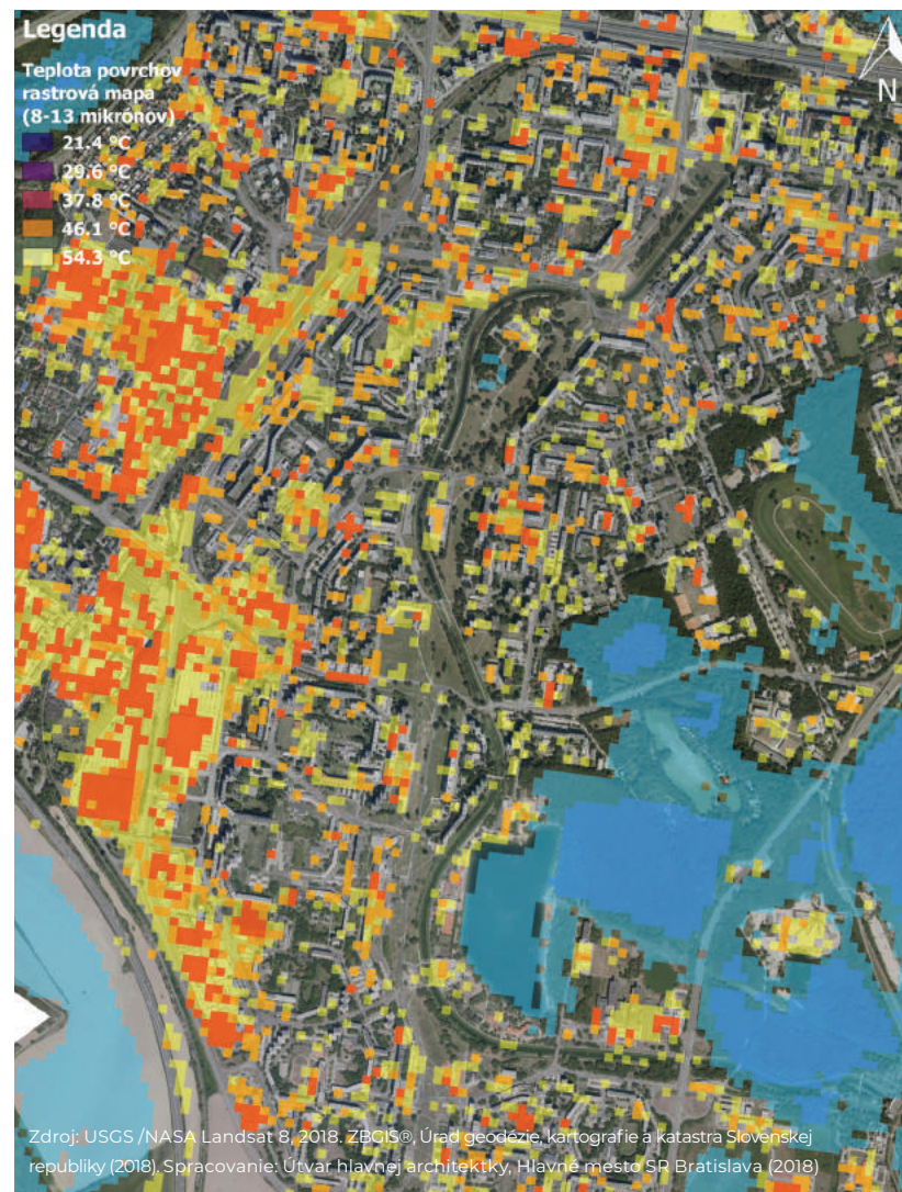
Obr. 26. Znázornenie ostrovov teplých a chladných povrchov s využitím multispektrálnej satelitnej snímky z programu NASA Landsat 8 v rozlíšení 30 m x 30 m z dňa 12.8.2018.
