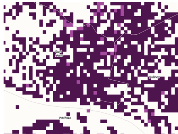
Model priepustnosti povrchu na území HM SR Bratislavy v rozlíšení 100m x 100m
